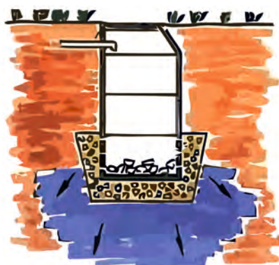
Проникване чрез дренажни кладенци
