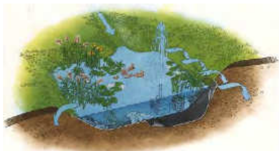
Едноставна шема на езерце за задржување на дождовница ( http://www.lfu.bayern.de/umweltwissen/doc/uw_88_umgang_mit_regenwasser.pdf )
