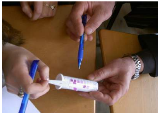
Benzile de testare a nitraților sunt ieftine iar probele de apă pot fi analizate rapid cu acestea
