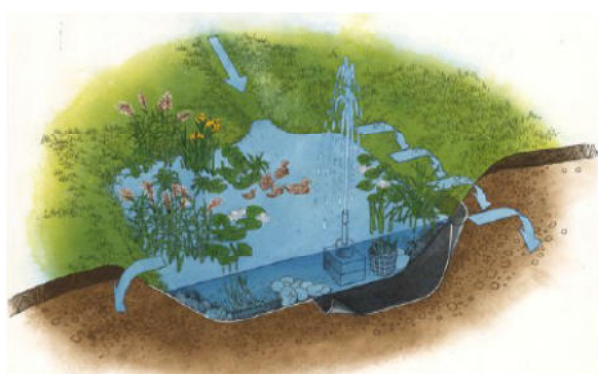
Схема простого пруда для удерживания дождевых вод ( http://www.lfu.bayern.de/umweltwissen/doc/uw_88_umgang_mit_regenwasser.pdf )
