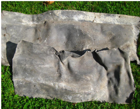
Свинец – тяжелый и ковкий металл. Ранее его использовали для изготовления кабелей и спаек. Свинец токсичен для человека.
