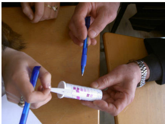
Тест-полоски на выявление в воде нитратов недороги и позволяют провести быстрый анализ качества воды
