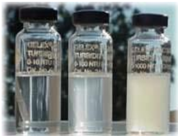
Mostre de turbiditate standard: 5, 50 și 500 NTU. Sursa: http://en.wikipedia.org/wiki/Turbidity
