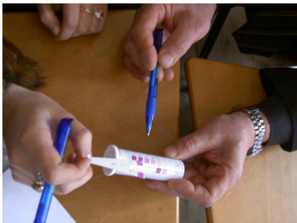
Нитрат –тест лентите се евтини и Примероците на вода брзо се анализираат
